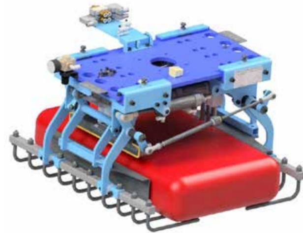
EL BRAZO ROBÓTICO OFRECE AUTOMATIZACIÓN EN EL ÁREA DE PALETIZADO. PUEDE MANEJAR HASTA 24 BOLSAS POR MINUTO DE 50 KG.\*
